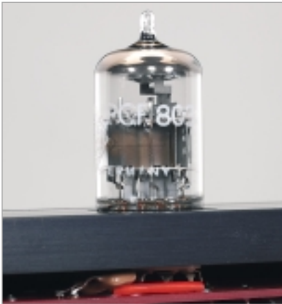
Die Erzeugung des invertierten Signals für den symmetrischen Betrieb bleibt den Röhren überlassen
