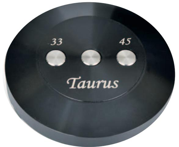
Subteller, auf dem der entsprechend ausgesparte Plattenteller aufliegt. Damit ist auch das Präzisions-Gleitlager, das ja gleichzeitig das Motorlager ist, schon montiert und somit wartungsfrei unzugänglich. Ein Vorteil, wenn man sich klar macht, dass mechanisch weniger kundige Hände so manchem Tellerlager schon beim Zusammenbau Schaden zufügen können.
