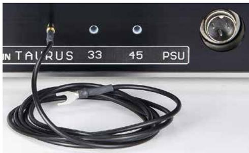
Auf der Rückseite sitzen hinter winzigen Öffnungen Mini-Potis zur Drehzahlfeinregulierung, und über eine Buchse lässt sich das Chassis separat erden.
