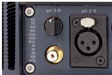
Der Abschlußwiderstand ist feinstufig anpassbar, die Anschlussvielfalt beeindruckend
