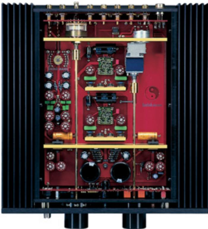
*Mit den seitlichen Kühlkörpern wirkt der neue Vorverstärker beinahe muskulös. Entdecken Sie das Motorpotentiometer, die optionale Phonoplatine, das Fernbedienungs-Empfangsauge und die kleine Maus?*
