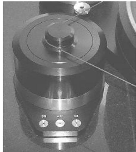
Die EMK des eingebauten Motorelementes wird einer Regelschaltung zugeführt, die darüber die Drehzahl mit einer einstellbaren Referenzspannung vergleicht. Es sind zwei Drehzahlen (des Plattentellers) von 33 1/3 und 45 sowie 0 U/min über eine aussen am Motor angebrachte Tastatur schaltbar. Die
